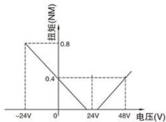
电压-扭矩曲线图 (20℃条件下)
